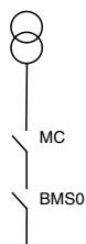
Selektivitätsgrenzstrom I_s [kA] für Selektivität zwischen BMS0-C... und MC... (Überlast- und Kurzschlussauslöser MC.. auf max. Wert einstellen)
